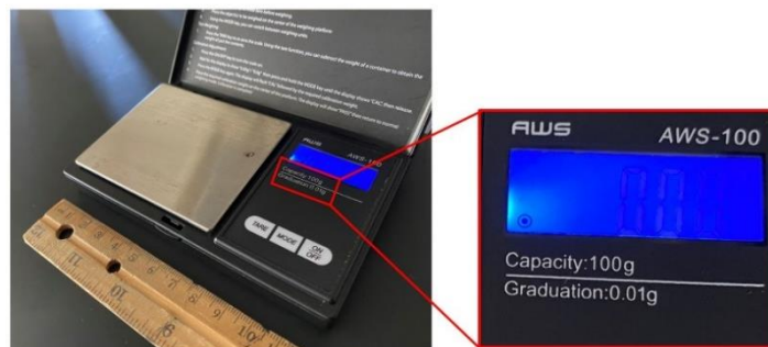
Figura 3. Balanza de precisión marca AWS Modelo AWS-100 con rango de 0.01-100g.
